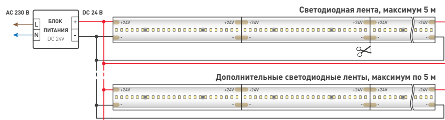
Схема 1. Подключение нескольких светодиодных лент с двух сторон
