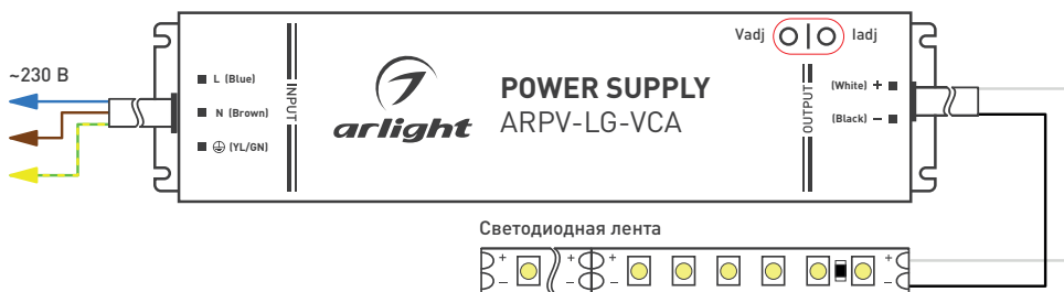
Рис. 1. Пример подключения источника питания
