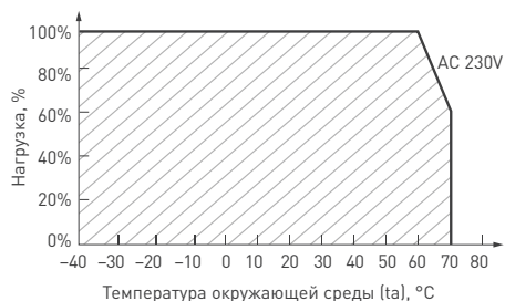
Рис. 3. Максимальная допустимая нагрузка, % от мощности источника
