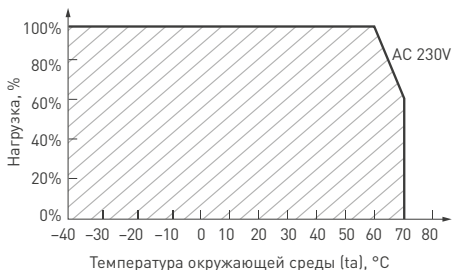
Рис. 3. Максимальная допустимая нагрузка, % от мощности источника
