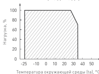
Рис. 6. Максимальная допустимая нагрузка, % от мощности источника
