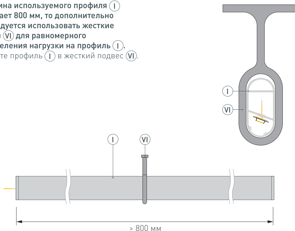
Рис. 1. Жесткий подвес ⑥ на профиле ①. Вид сбоку
